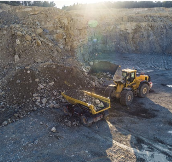
Chargement d'un dumper électrique autonome dans la carrière du Gabenchopf.
